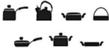
Aufgrund der besonderen Funktionsweise des Induktionskochfeldes eignet sich nur Kochgeschirr mit einem magnetisierbaren Boden.
