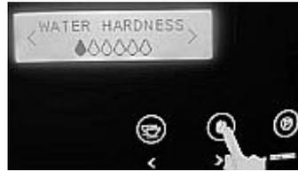
2. En appuyant sur les touches de réglage « < » ou « > », choisir l'option « Dureté de l'eau » et confirmer à l'aide de la touche de sélection.
