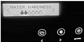
3. Maintenant, en appuyant sur les touches « < » ou « > », choisir le degré de dureté de l'eau dans le réseau de distribution local et confirmer à l'aide de la touche de sélection.
